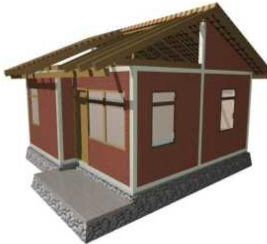
**Gambar 6.13.** Ilustrasi Rumah Dinding Bata Dengan Rangka Beton Bertulang Pondasi Batu Kali
